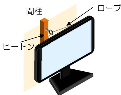
壁からヒートン及びロープ等で転倒防止をする場合は、ヒートンは壁の強度のある間柱等に取付けるとともに、テレビの重量に耐えるヒートン（リング式）及びロープを選びます。
